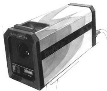
Рис. 5. Специальные "ProReflex MCU" камеры системы Qualisys
