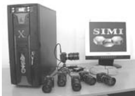
Рис. 10. Высокоскоростные решения SIMI с программным обеспечением 3-мерного анализа движения компьютером, 6 камерами (A301fc) и несколькими сотнями метров кабеля
